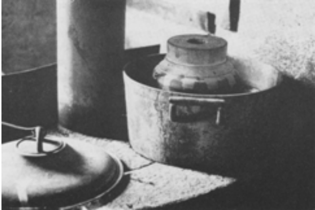
Cerclé, le moyeu est mis à bouillir pour ramollir les mortaises.
