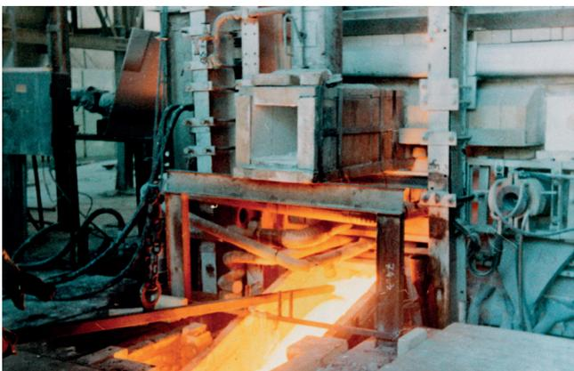
**Figure 1** À la fin d'une « campagne », le four doit être vidé et les briques réfractaires changées. Les habitants de Moutier allaient régulièrement assister à ce spectacle. (Photo non datée mise à disposition par le Musée du Tour automatique et d'Histoire de Moutier)
