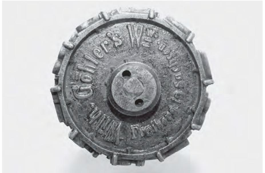
Figure 4 : Le marteau de cubage permettait de marquer un numéro d'identification sur chaque grume ou chaque lot de bois de chauffe. Le levier sert à avancer d'une unité. Ce marquage se fait maintenant grâce à une plaquette en plastique portant un numéro. Photo J.-L. Merçay.
